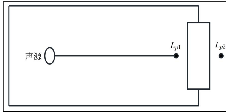
图 4-2 室内声源等效为室外声源图例
