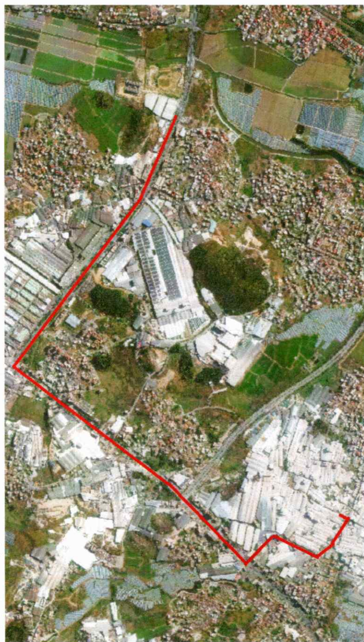
3.10 千伏卓翔线电力线路路径简图
