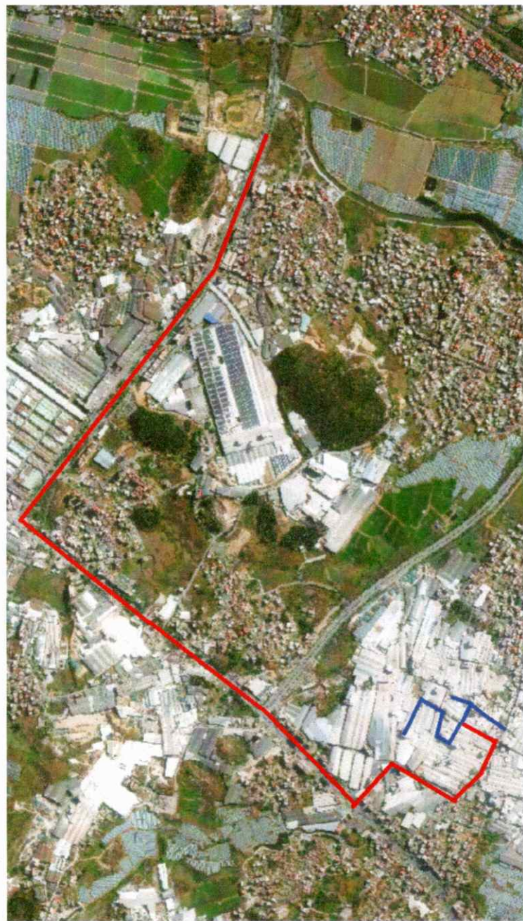
5.10 千伏昆鹏线电力线路路径简图
