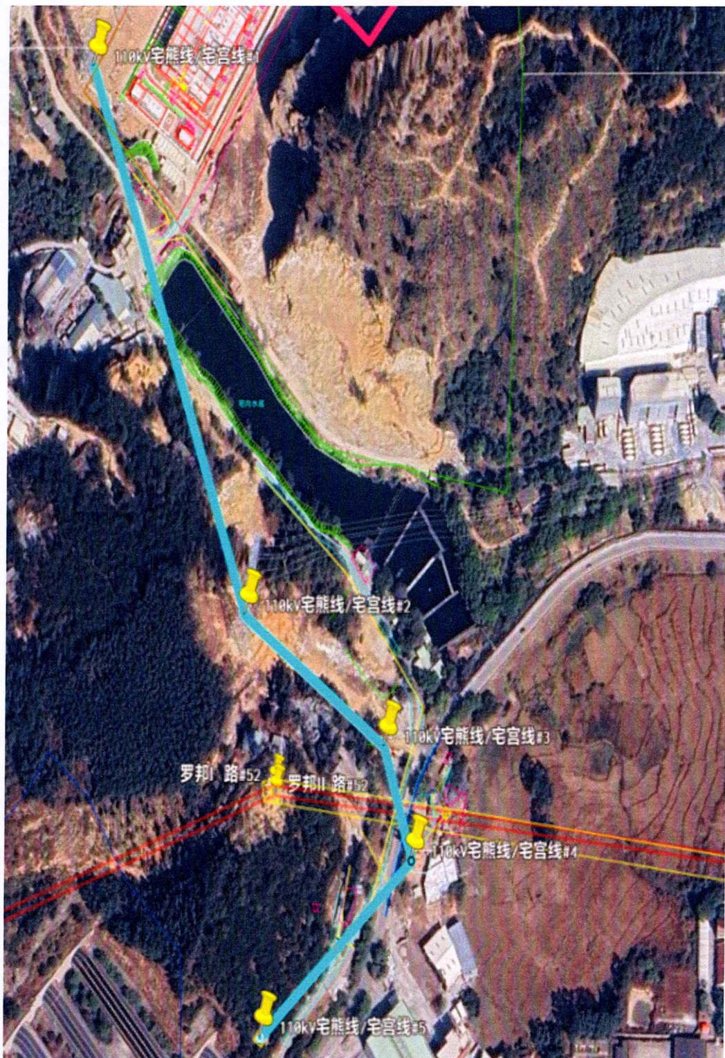
110 千伏宅熊线/宅宫线线路路径简图
