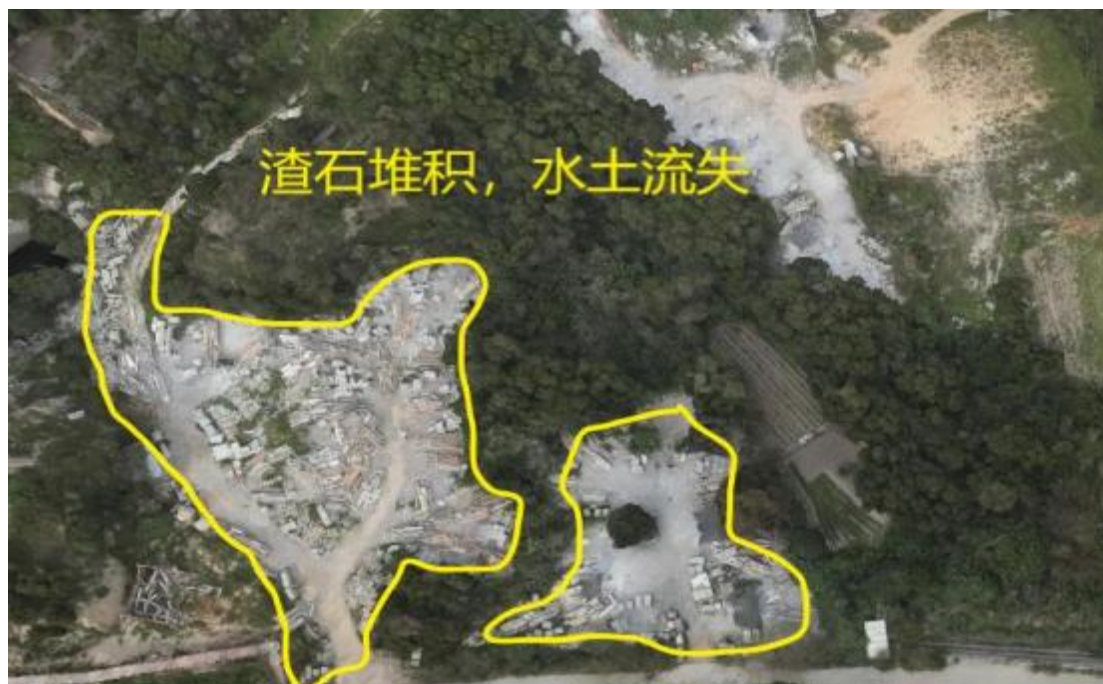
照片 3-54 项目区土地资源破坏现状图（东北向拍摄）
