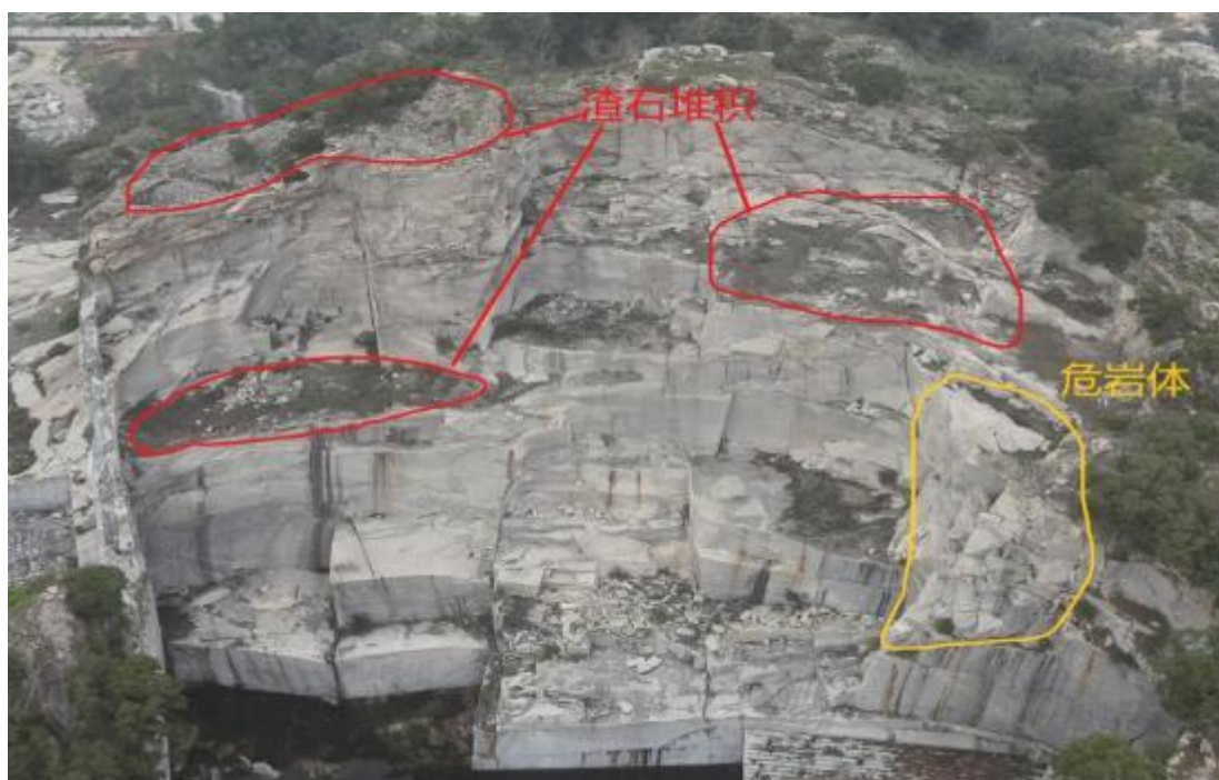
照片 3-53 项目区渣石堆积易崩塌地质灾害隐患现状图（西向拍摄）
