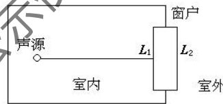
图 4.3 室内声源等效为室外声源图例
