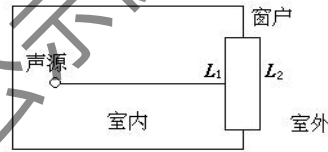
图 4.3 室内声源等效为室外声源图例
