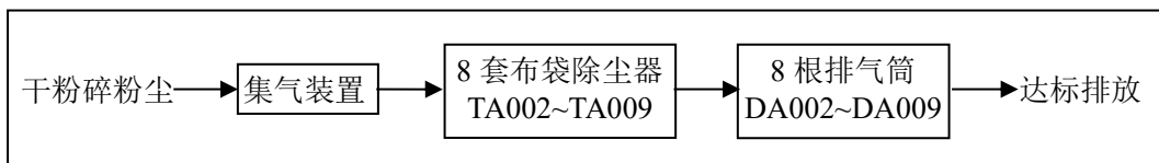
图4-2 项目干粉碎粉尘处理工艺流程图
