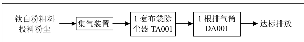
图4-1 项目钛白粉粗料投料粉尘处理工艺流程图
