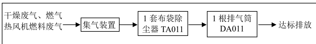
图4-4 项目干燥废气、燃料废气处理工艺流程图
